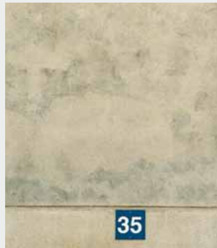
Örnek B: Daha az seyreltilmiş düşük pigmentli bitiş
