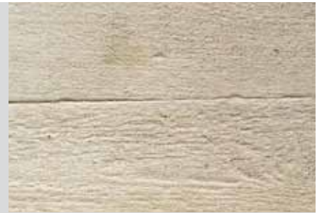
Sünger, sert kauçuk mala veya kaba tahta kalıp ile oluşturulan doku korunur
